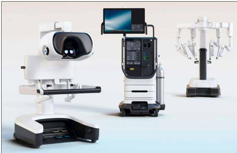
Figura 1. Sistema Cirúrgico da Vinci 5 ( Intuitive Surgical , CA, USA). O sistema é composto por: Console do Cirurgião, Carrinho de Visão e Carrinho do Paciente (da esquerda para a direita na imagem).
